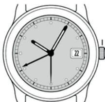
Заводная головка отвинчена. Для ручного подзавода вращайте заводную головку по часовой стрелке; вращение против часовой стрелки невозможно. Во время первого завода или после остановки часов сделайте минимум 25 оборотов для частичного завода часов.
